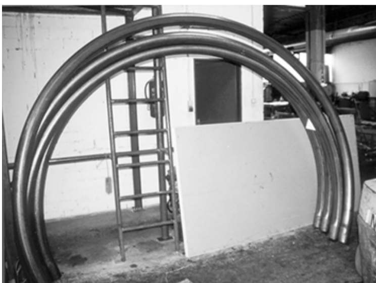
Kaltgefertigter Rohrbogen aus nahtlosem Stahlrohr mit der Rohrabmessung 114,3 x 3,6 mm.
